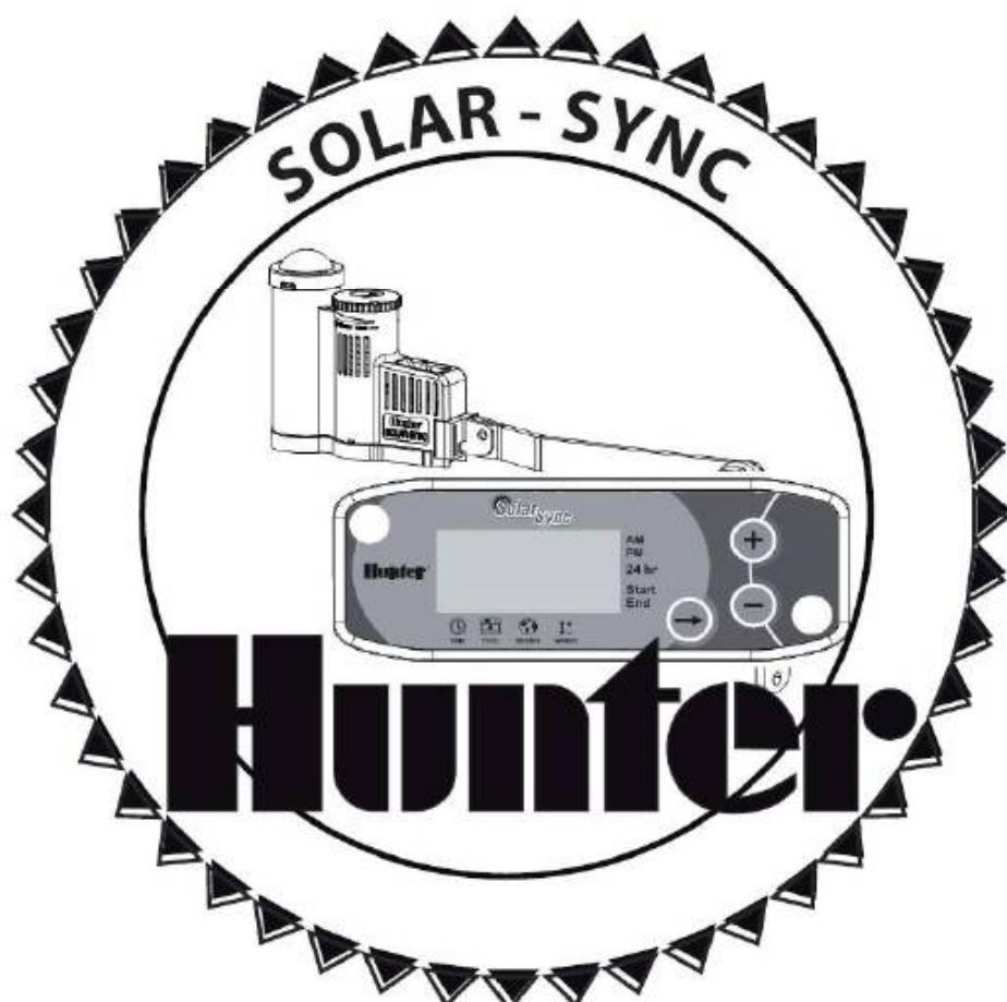
Solar-Sync je nadřazený senzorový systém, který pokud je připojen k ovládací jednotce Hunter řady Pro-C, Pro-CC nebo ICC automaticky přizpůsobuje délku závlahy aktuálním klimatickým podmínkám. Solar-Sync senzor měří teplotu a intenzitu slunečního záření, na základě naměřených údajů vypočítá denně ztráty vody vzniklé odparem vody (ET, evapotranspirace).
