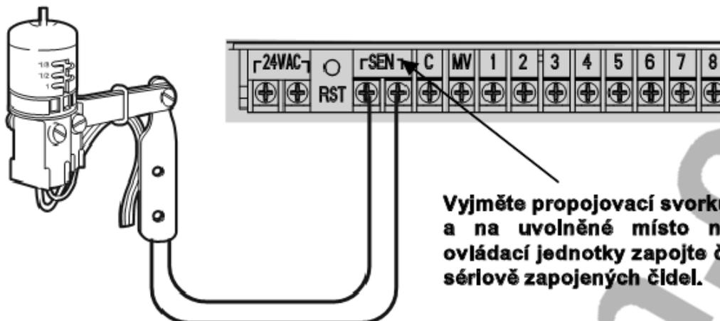
Vyměňte propojovací svorku z pozice SEN a na uvolněné místo na svorkovnici ovládací jednotky zapojte čidlo. Při aktivaci čidla dojde k zablokování závlahového systému a na displeji ovládací jednotky XCH se zobrazí symboly **OFF** a ☂ (přepínač **SENSOR** v poloze **ZAP**). Čidlo v tuto chvíli blokuje automatický režim závlahy a rovněž manuální spuštění cyklu (**CYKLUS MANUÁLNĚ**). Manuální spuštění jednotlivých sekcí (**SEKCE MANUÁLNĚ**) však lze provést.
